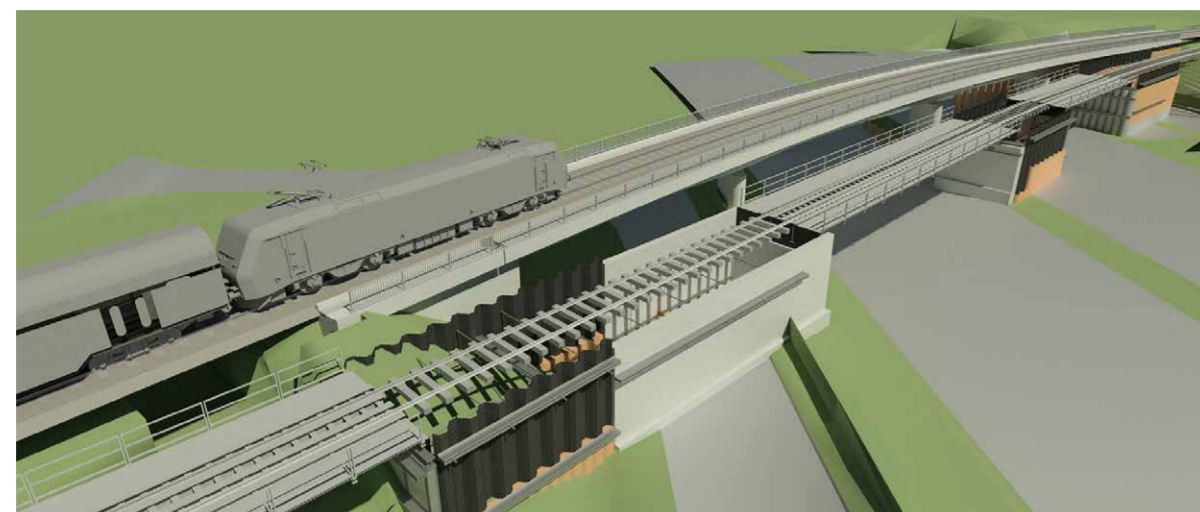
BIM-Modell Eisenbahnüberführung BAB A81 Böblingen © DB AG
